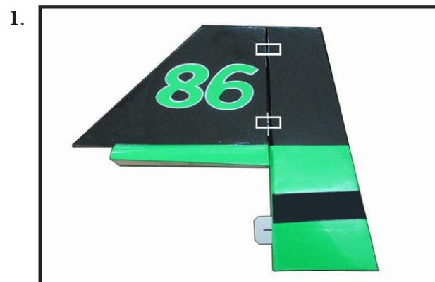
**INSTALL RUDDER CONTROL HORN**
