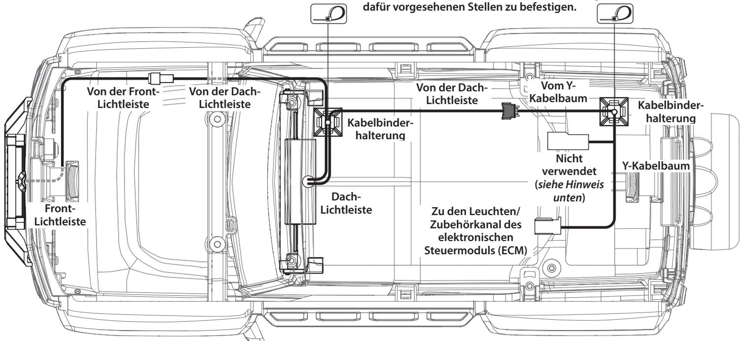
**Hinweis:** Wenn dies Karosserie-Beleuchtungseinheit Nr. 9783 zuvor an der Karosserie montiert wurde, stecken Sie den Stecker Nr. 9783 in den mitgelieferten Y-Kabelbaum.
