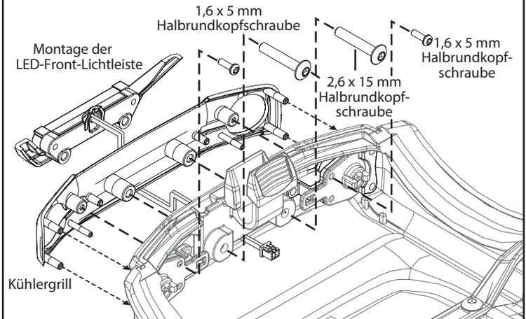
Hinweis: Die 2,6 x 15 mm große BCS-Schraube durchbricht den Kühlergrill während der Installation.
