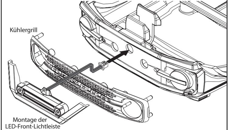
**A6.** Setzen Sie den Kühlergrill wieder ein. Achten Sie darauf, dass zwischen der Karosserie und Kühlergrill keine Kabel eingeklemmt werden, bevor Sie Schrauben anziehen.
