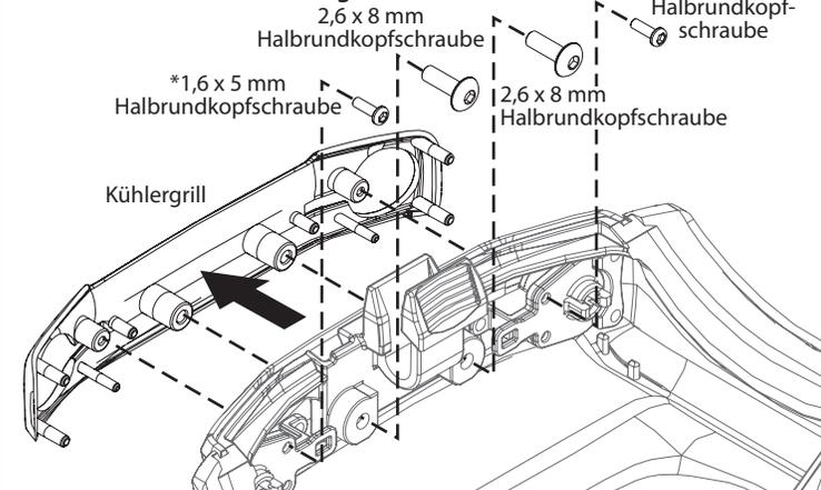
\*Hinweis: Heben Sie die 1,6 x 5 mm großen Halbrundkopfschrauben für eine Wiederverwendung auf. Sollte zuvor Beleuchtungseinheit Nr. 9783 an der Karosserie montiert gewesen sein, heben Sie die 1,6 x 7 mm Halbrundkopfschrauben aus diesem Kit für eine Wiederverwendung auf.
