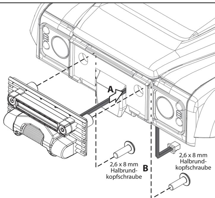
**A4.** Führen Sie den Kabelbaum von der LED-Front-Lichtleiste in den Schlitz zwischen der Karosserieverriegelung und dem LKW-Aufbau (A).
