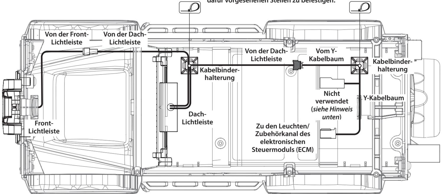
**Hinweis:** Wenn dies Karosserie-Beleuchtungseinheit Nr. 9784 zuvor an der Karosserie montiert wurde, stecken Sie den Stecker Nr. 9784 in den mitgelieferten Y-Kabelbaum.
