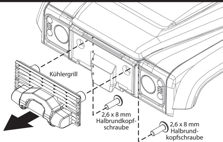
**A1.** Entfernen Sie den vorhandenen Kühlergrill von der Karosserie. Heben Sie alle Schrauben für die spätere Wiederverwendung auf.
