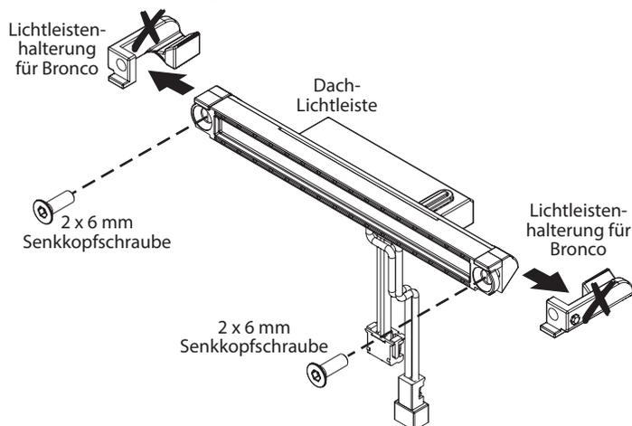
**B3.** Rasten Sie die Montagehalterungen der linken und rechten Dach-Lichtleiste am ExoCage (A) ein.
