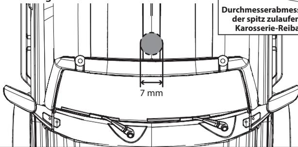
**B3.** LED-Dach-Lichtleiste in Dachträger (A) einpassen.
