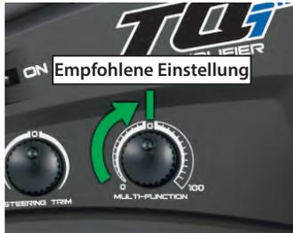
Drehen Sie den Schalter im Uhrzeigersinn, um die Hilfeleistung zu erhöhen, oder gegen den Uhrzeigersinn, um die Hilfeleistung zu verringern.
