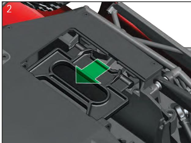
3. Drehen Sie den Niederhalter nach oben, um Zugang zum Batteriefach zu erhalten. Lehnen Sie den Batterieniederhalter in der offenen Position gegen das Chassis. **Hinweis:** Der Batterieniederhalter bleibt am Chassis angebracht.
