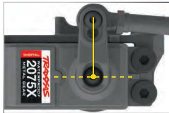
8. Überprüfen Sie die Funktion des Servos, indem Sie das Lenkrad vor und zurück drehen, um sicherzustellen, dass der Mechanismus korrekt zentriert wurde und dass Sie gleichen Hub in beiden Richtungen haben. Verwenden Sie den Schalter für die Lenkungs-Trimmung am Sender für die Feineinstellung des Servohorns, sodass Ihr Modell gerade aus fährt, wenn sich das Lenkrad in der Mittelposition befindet.
