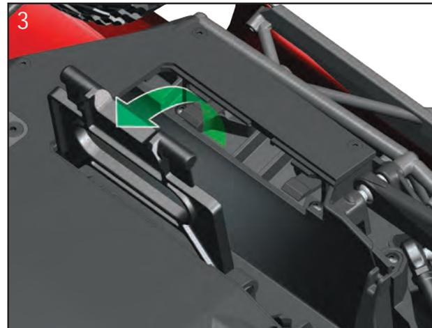
4. Setzen Sie einen voll geladenen Batteriepack in das Batteriefach ein und wiederholen Sie diesen Schritt für den zweiten Batteriepack, falls zwei verwendet werden. Setzen Sie den zweiten Batterie auf den ersten.
