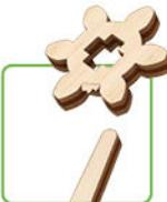
**ENG** Clean the burrs on the parts using the universal "Helper" (H) instrument. **UKR** Очистіть задирки на деталях за допомогою універсального інструменту "Helper" (H).
