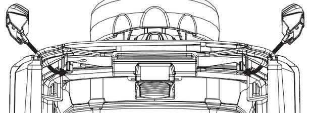
4. Montieren Sie den rechten und dann den linken LED-Rücklicht-Kabelstrang.
