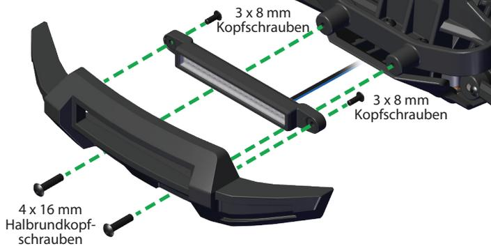
Entnehmen Sie die 4 x 16 mm Halbrundkopfschrauben (2), um den vorderen Stoßfänger von der Stoßfängerhalterung zu entfernen. Installieren Sie die vordere LED-Lichtleiste mit den im Lieferumfang enthaltenen 3 x 8 mm-Halbrundschrauben (2) am vorderen Stoßfänger. Bauen Sie den vorderen Stoßfänger wieder an. Schließen Sie den Stecker am Anschluss des Hochspannungs-Leistungsverstärkers (weiß) ein.
