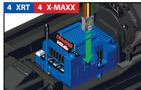
Stecken Sie den 8-Pin-Stecker vom Hochspannungs-Leistungsverstärker am Zusatz-Port am elektronischen Geschwindigkeitsregler ein. Der Hochspannungs-Leistungsverstärker und die Lichter werden eingeschaltet, wenn der elektronische Geschwindigkeitsregler eingeschaltet wird.
