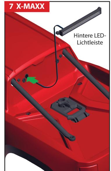
Installieren Sie die hintere LED-Lichtleistenhalterung mit den im Lieferumfang enthaltenen 3 x 10 mm-Flachkopfschrauben (2) an der Karosserie Ihres Modells.
