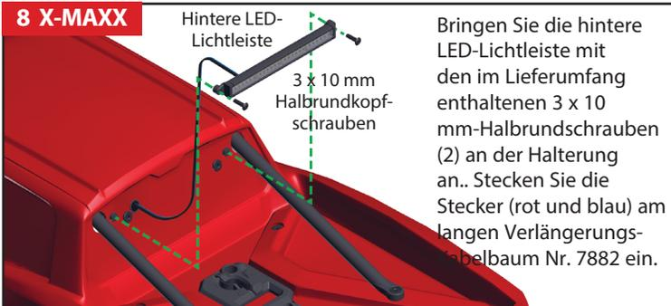
Bringen Sie die hintere LED-Lichtleiste mit den im Lieferumfang enthaltenen 3 x 10 mm-Halbrundschrauben (2) an der Halterung an. Stecken Sie die Stecker (rot und blau) am langen Verlängerungskabelbaum Nr. 7882 ein.
