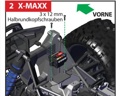
Installieren Sie den Hochspannungs-Leistungsverstärker in das Chassis ein. Vergewissern Sie sich, dass die Anschlüsse am Hochspannungs-Leistungsverstärker in Richtung der Fahrzeugfront zeigen. Sichern Sie sie mit den 3 x 12 mm-Halbrundschraben.
