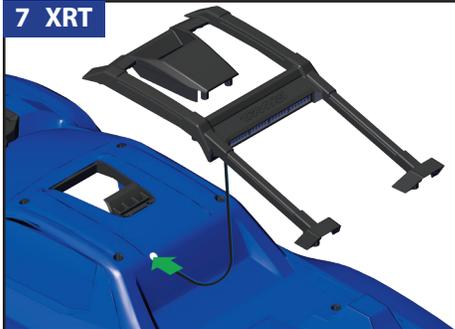
Führen Sie die Stecker der hinteren Lichtleiste durch das 8 mm aufgeweitete Loch auf die Innenseite der Karosserie Ihres Modells. Bringen Sie den Dachrahmenplatte wieder an. Stecken Sie die Stecker (rot und blau) am langen Verlängerungs-Kabelbaum Nr. 7882 ein.
