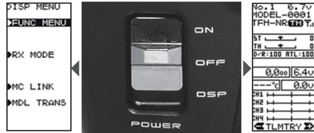
Diesen Modus können sie auch bei einem Wettbewerb nutzen, um Einstellungen vorzunehmen ohne andere zu stören. Der Kontrast des LC-Displays ist einstellbar und bei Betätigung der Tastatur schaltet sich die Hintergrundbeleuchtung ein, um auch bei schwierigen Lichtverhältnissen (Sonneneinstrahlung, blendende Scheinwerfer in der Halle) eine gute Ablesbarkeit zu gewährleisten.
