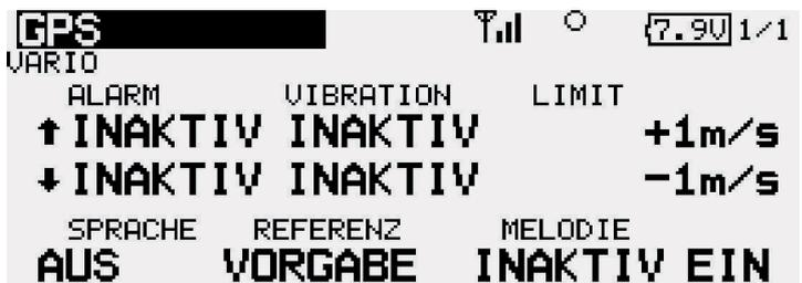
Displaydarstellung des Telemetrie Monitor und Sensormenüs im Sender FX-32
