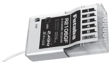
Keine Quarze, keine Frequenzkanalwahl und höchste Sicherheit vor Störungen und Elektrosmog durch 2,4 GHz FHSS Technologie. Bestmögliche Unterdrückung von Stör-signalen durch schnelles Frequenz Hopping. Frequenz Hopping System mit 30 Kanälen a 1,5 MHz im Bereich 2404 - 2447,5 MHz. Maximal 28 Benutzer gleichzeitig.
