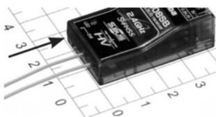
Durch Drücken der Taste "SW" wird im Empfänger automatisch die individuelle Codenummer des Senders gespeichert. Durch diese "Bindung" reagiert der Empfänger nur noch auf die Signale des angebondenen Senders.
