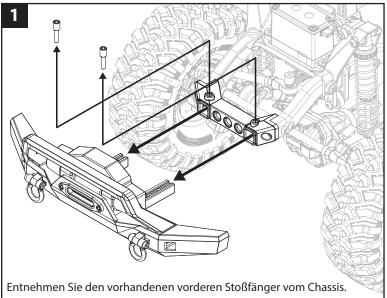
Ihr neuer vorderer Stoßfänger ist für den Einsatz mit der 8088 LED-Lichtleiste (separat erhältlich) ausgelegt. Installieren Sie ihn wie unten abgebildet am Stoßfänger. *Das 8028 LED-Beleuchtungsmodul (auch optional erhältlich) ist erforderlich, um die Lichtleiste mit Strom zu versorgen.*3 x 10-mm-Halbrundkopfschraube
