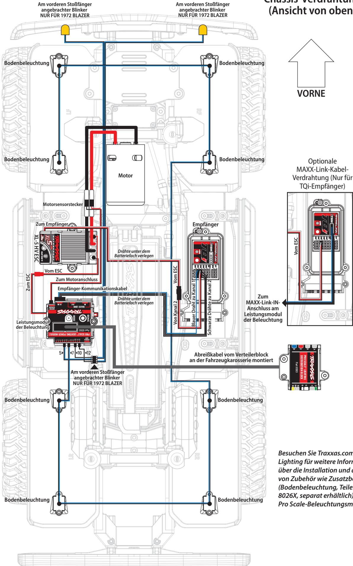
Besuchen Sie [Traxxas.com/ProScale-Lighting](http://Traxxas.com/ProScale-Lighting) für weitere Informationen über die Installation und den Anschluss von Zubehör wie Zusatzbeleuchtung (Bodenbeleuchtung, Teilenummer 8026X, separat erhältlich) an das Pro Scale-Beleuchtungsmodul.
