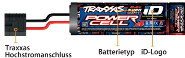
NiMH-Batterien (Nickel-Metall-Hybrid) sind aus 6, 7 oder 8 runden Batteriezellen aufgebaut, die zusammen gelötet und mit einem Schrumpfschlauch umwickelt sind. NiMH-Batterien haben kein separates Ausgleichskabel.
